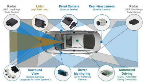
[그림 1] 자율주행 인지센서 유형 및 적용기술
